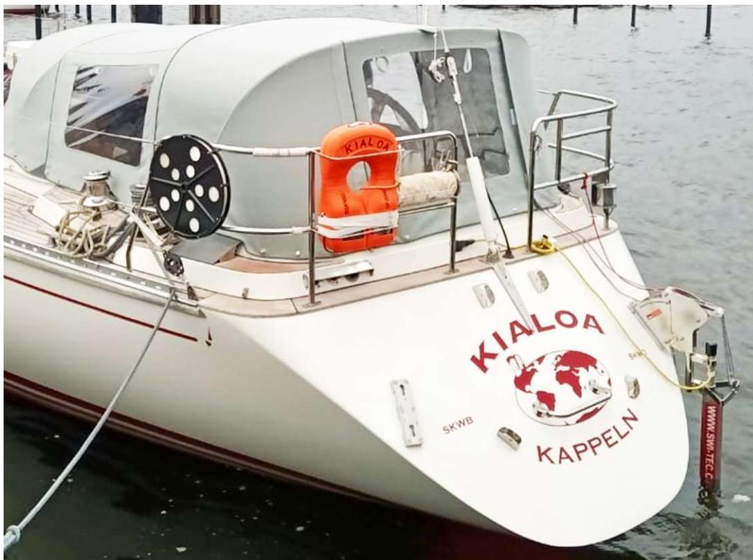
*SWITEC-Hydrogenerator (hier für Steuerbordbug montiert), die Badeleiter fehlt noch...*
