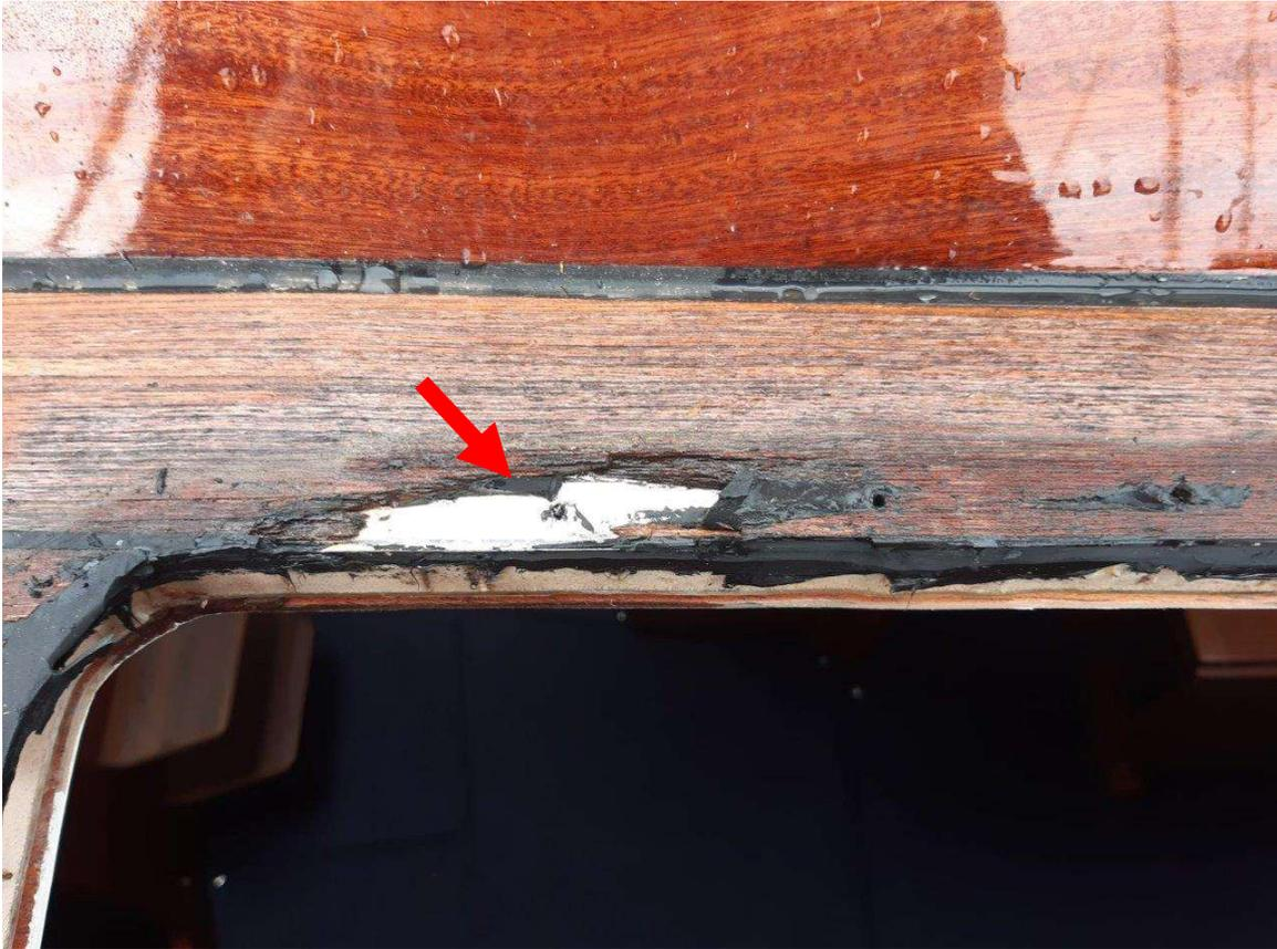
*Oben: Ausgebrochenes Holzstück unter dem Dichtflansch des Lukenrahmens über dem Kartentisch, einem der feuchtigkeitsempfindlichsten Bereiche auf dem ganzen Boot.*
