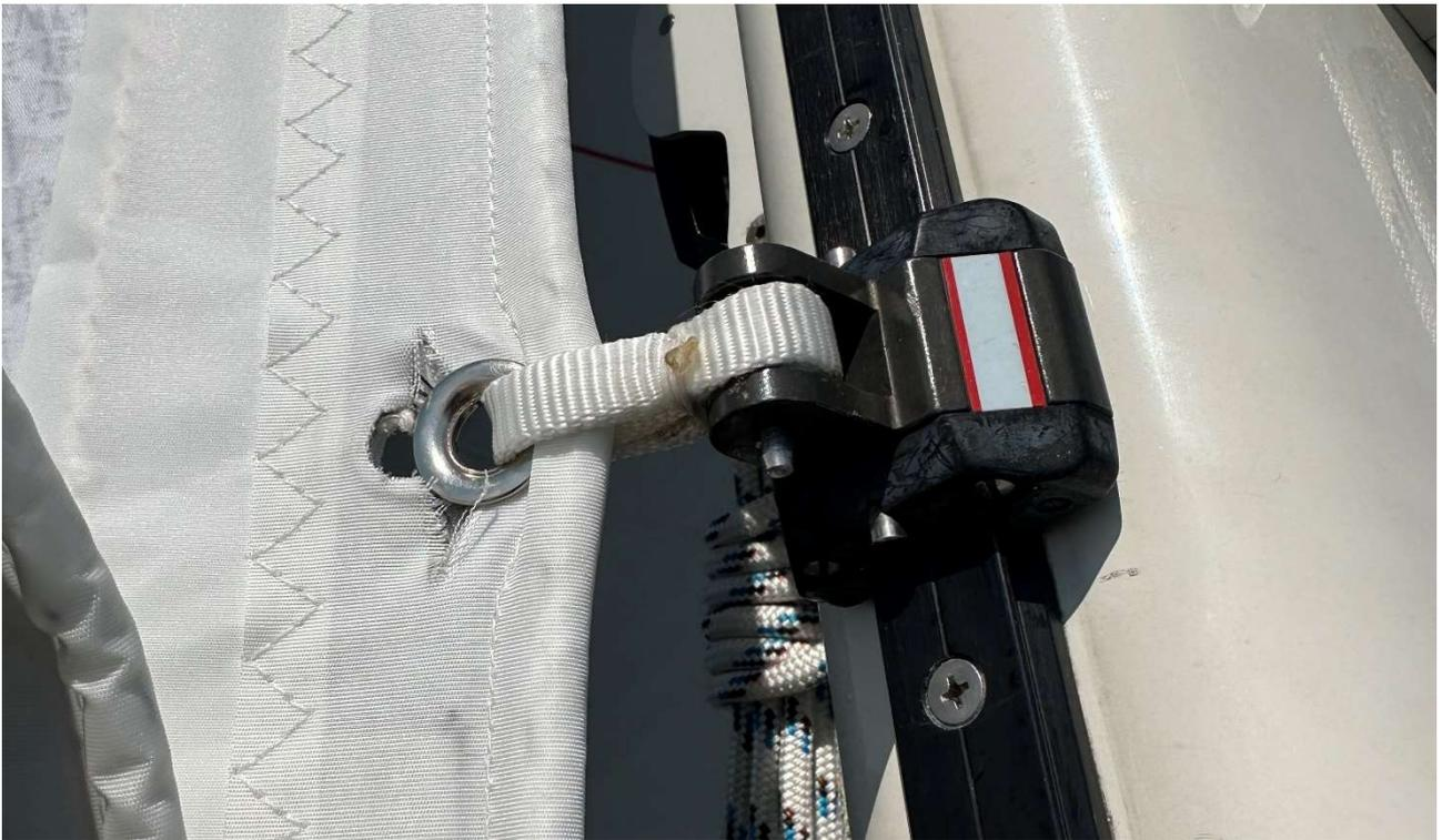
*Das Gatchen ist ausgerissen, weil das Gurtband zwischen Vorliek und Rutscher zu kurz war. Im gerefften Zustand stauen sich die Rutscher auf und der Weg zwischen Vorliek und Schothorn wird länger, was zu mehr Spannung führt. Unten: Mit Bordmitteln beim Segeln repariert, dafür hätte ich nicht einmal beim Segelmacher angerufen.*
