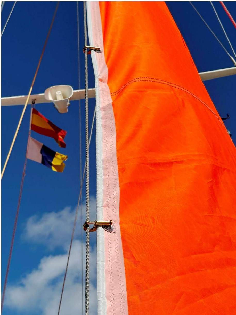
Die ungleichmäßige Spannung im Vorliek der neuen Sturmfock ist inakzeptabel...
